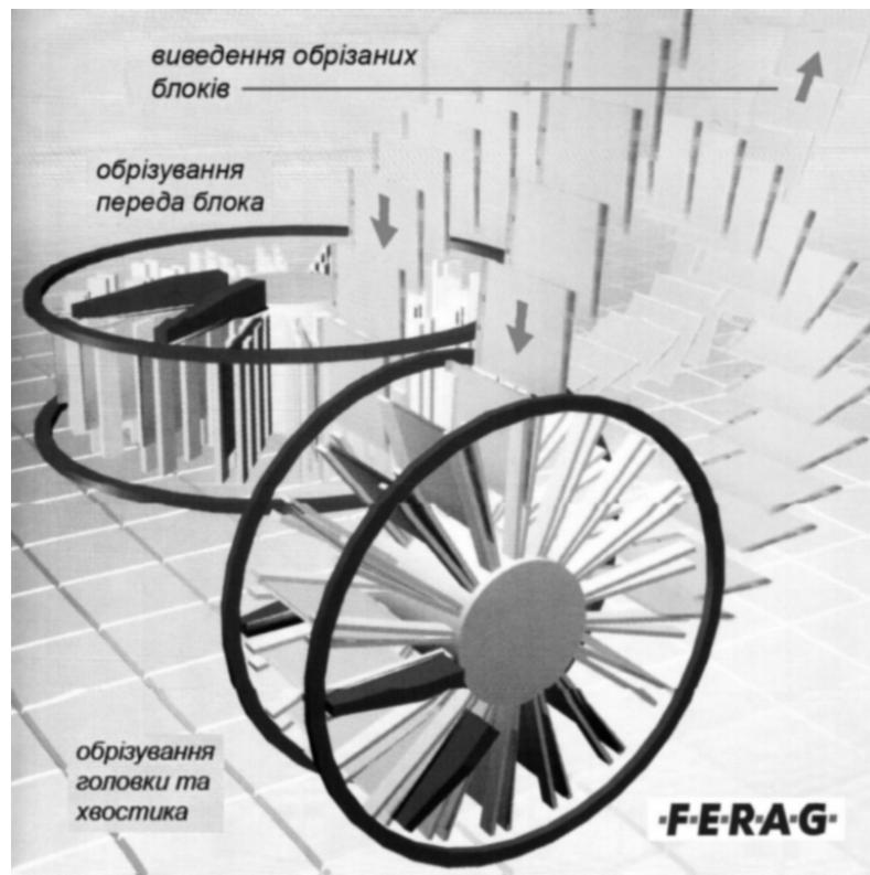
Рис. 1.14. Принципова схема пристрою для безвистійного обрізування пласкими різальними інструментами КЖБ фірми *FERAG*:
